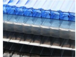
Come noto, i raggi ultravioletti tendono a provocare una rapida degradazione dei polimeri: il policarbonato trasparente, in particolare, è sensibile all'irraggiamento a bassa lunghezza d'onda, ricco di energia, con effetti deleteri sia sulla qualità ottica (ingiallimento) che sulle proprietà meccaniche delle lastre.
