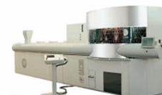
L'impianto a 64 cavità, progettato per produrre fino a 1.600 capsule al minuto, è stato installato nel primo trimestre di quest'anno.
