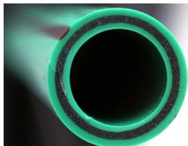
Wavin ha introdotto sul mercato Fiber Basalt Plus, nuova linea di tubazioni PP-RCT (polipropilene random con speciale struttura cristallina) a 3 strati caratterizzata da un rinforzo in fibra di basalto, destinata al settore delle costruzioni. In particolare, i tubi sono stati progettati per trasporto di acqua calda e fredda, sistemi di riscaldamento centralizzati, sistemi di raffrescamento, per distribuzione sanitaria e aria compressa.
