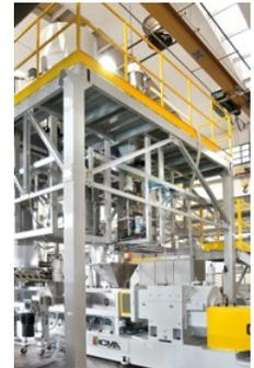
Basati su estrusori co-rotanti Icma ad alta efficienza, con produttività oraria di 3.000 kg, gli impianti integrano sistemi di movimentazione materiali, dosaggio e unità di taglio. Il progetto è stato ottimizzato per contenere i consumi energetici delle macchine e ridurre al minimo le emissioni acustiche.
