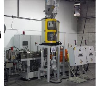
La linea, equipaggiata con un estrusore bivate corotante da 50 mm di diametro, appartenente alla famiglia MCM-HT a coppia elevata, è in grado di produrre una vasta gamma di compositi a base di tecnopolimeri e compound caricati.
