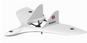
Il drone (anche se sarebbe più corretto definirlo UAV, Unmanned Aerial Vehicles) è lungo 1.579 mm e ha un'apertura alare di 2.168 mm. Per ridurre il peso e il numero dei componenti, senza sacrificare la rigidità e la resistenza meccanica, la struttura è in composito al carbonio e alluminio intimamente connessi grazie alla nuova tecnologia Polymetac, di cui non sono stati forniti dettagli.
