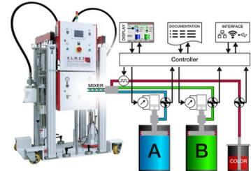
L'impiego di un misuratore di portata ad alta risoluzione per l'aggiunta controllata di coloranti e additivi consente ora di determinare i volumi di dosaggio con una precisione di 640.000 incrementi/litro - fa sapere l'azienda -. Sulla base di questi valori, il sistema è in grado di controllare il dosaggio in conformità con la percentuale impostata sul pannello touch-screen e generare allo stesso tempo i corrispondenti valori per la documentazione.
