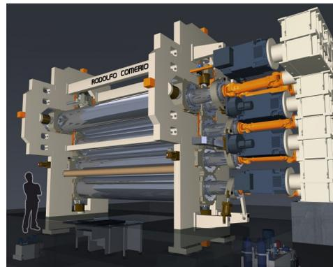
Dotate di quattro e cinque cilindri da 870 mm, le due calandre si caratterizzano per una larghezza di lavoro di 5 metri e un peso di trenta tonnellate, che richiederà - per la spedizione oltreoceano - l'utilizzo di 60 container. La commessa, del valore di circa 10 milioni di euro, consolida la presenza dell'azienda sul mercato asiatico.
