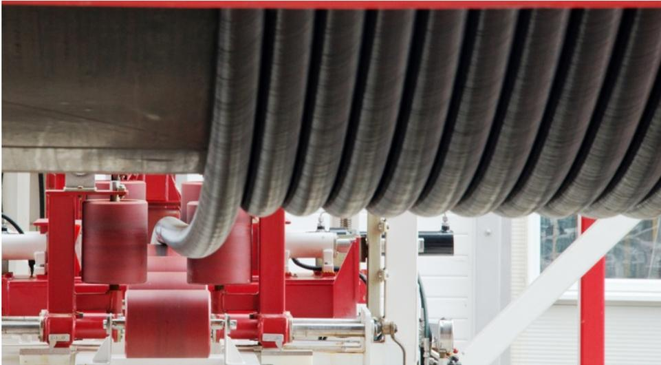
Utilizzando un composito a base di PEEK Victrex con alto tenore di fibra di carbonio e fibra di vetro S-2, Magma Global Limited ha messo a punto la linea di tubi m-pipe per applicazioni oil&gas, con i quali è stata realizzata la linea d'intervento più lunga fino ad oggi realizzata.
