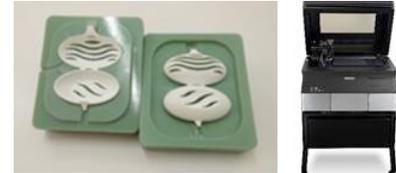
**INSERTI STAMPO PIÙ VELOCI.** Con la stampante Objet30 Prime si possono infatti ottenere rapidamente stampi in fotopolimeri in grado di resistere alle alte pressioni e temperature di stampaggio, almeno per un numero limitato di cicli, soluzione interessante quando si devono produrre serie limitate di prototipi o componenti in plastica. Il tutto in tempi molto contenuti, rispetto alle settimane necessarie per la realizzazione dei tradizionali inserti per stampi.
