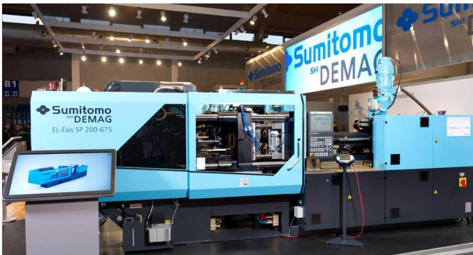
**LA PIÙ VELOCE PER IML.** Degna di nota sarà la EI-Exis SP 200 (foto sopra) che stamperà con un tempo di ciclo inferiore a due secondi quattro tazze in polipropilene decorate nello stampo mediante IML, estratte mediante un robot veloce ad ingresso laterale (fornito dalla olandese Brink insieme allo stampo) che provvede anche all'inserimento delle etichette nello stampo.
