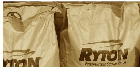
Due di questi sono inediti - Ryton R-4-242 e Ryton R-7-232, mentre il terzo (Ryton R-4-232) è un grado esistente sottoposto con successo alle prove per ottenere l'omologazione. I tipi R-4-232 e R-4-242 sono rinforzati con il 40% fibra vetro, tenore che sale al 65% (tra fibre e cariche minerali) nel grado R-7-232, destinato a componenti che richiedono superiori prestazioni meccaniche.
