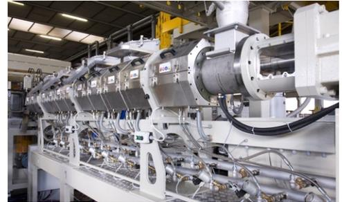
**ESTRUSORE UNION.** La linea, fornita da Union, è basata su un estrusore bivate per la produzione di lamine PET mono e accoppiate utilizzando sia materiale vergine, sia scaglie di PET post consumo. Entrerà in funzione nel mese di novembre, con una capacità di 15mila tonnellate di PET all'anno. L'investimento fa parte del piano di oltre 20 milioni di euro in tre anni per l'innovazione delle tecnologie e l'incremento delle capacità produttive.
