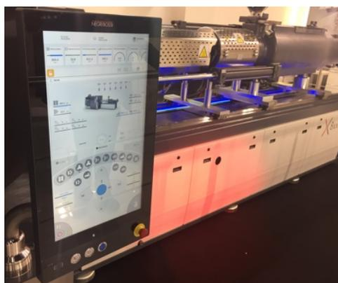
ARRIVA LA JANUS ST. Serie ELE e Concept X non erano le sole novità presentate in Fiera. All'inizio di quest'anno la piattaforma ST (Servo Touch) - che combina l'azionamento servoidraulico con il nuovo controllo Tactus - è stata applicata alle gamme EOS e Cambio con forza di chiusura da 70 a 500 tonnellate, migliorando le prestazioni e riducendo al contempo i consumi energetici. Il controllo Tactus è ora montato anche sulla serie Janus nei nuovi modelli contraddistinti dalla sigla ST.
