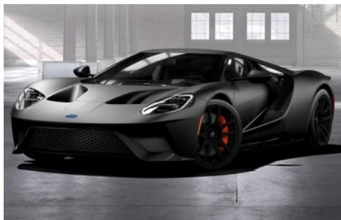
Altre particolarità sono il trattamento delle superfici per migliorare l'aerodinamica e l'utilizzo di vetro Gorilla Glass, prodotto dalla Corning, per il parabrezza e il lunotto copri-motore; si tratta dello stesso materiale utilizzato negli schermi degli smartphone, adattato per usi automotive, scelto per ridurre ulteriormente il peso (il risparmio è di 5 kg) senza sacrificare la sicurezza, grazie alla struttura a 3 strati in vetro e termoplastica.
