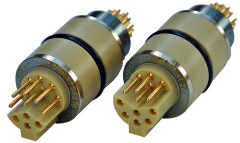
I connettori elettrici KTK vengono prodotti in genere utilizzando materiali termoidurenti a matrice epossidica con rinforzo in fibra di vetro, che possono però rompersi o scheggiarsi in condizioni critiche. Per questa ragione, Rampart Products, prima nel settore, ha deciso di passare al PEEK, ottenendo una resistenza all'urto due volte superiore.
