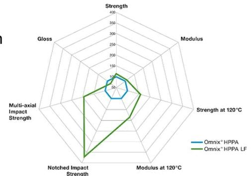
La serie Omnix è stata formulata dal gruppo belga per raggiungere prestazioni in termini di resistenza alle alte temperature e stabilità idrolitica che le convenzionali poliammidi 66 caricate non sono in grado di garantire. La rigidità è superiore del 10-15% a temperatura ambiente (23°C), incremento che sale all'85% salendo col termometro (120°C). Nettamente superiori anche i valori di resistenza all'intaglio e all'impatto multiassiale, grazie alla presenza di fibre lunghe nella matrice.
