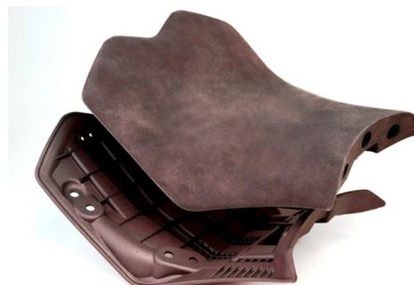
Il grado Windform RL, dove “RL” sta per “rubber like”, è un elastomero termoplastico durevole, con funzionalità e flessibilità simili alla gomma, adatto per applicazioni di manifattura additiva che richiedono geometrie complesse e un alto grado di elasticità mediante sinterizzazione selettiva a mezzo laser. La durezza può variare da un minimo di 45 Shore A ad un massimo di 80 Shore A.
