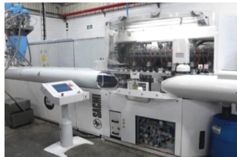
Con 64 cavità, la macchina è in grado di produrre fino a 1.600 pezzi al minuto, con diverso design utilizzando lo stesso stampo (in questo caso, una capsula per acqua e una per CSD), poiché lo spessore della parte superiore può essere impostato indipendentemente, via interfaccia operatore. Il tempo di ciclo è di soli 2,4 secondi, secondo i dati forniti dal costruttore italiano.
