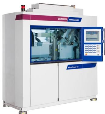
La macchina al centro della cella di lavoro in camera bianca è una MicroPower 15/10 con forza di chiusura di sole 15 tonnellate, allestita con uno stampo a due cavità, tavola rotante, robot per la rimozione dei pezzi e sistema integrato per il controllo qualità mediante visione. Il modulo clean-room, dove avvengono tutte le fasi di stampaggio e verifica dei pezzi, è di classe 6 secondo lo standard ISO 14644-1.
