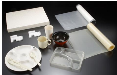
La certificazione attesta che le resine si biodegradano almeno per il 90% entro sei mesi in ambiente marino con temperatura di 30°C.
