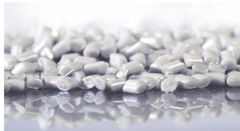
Vestamid HTplus TGP3717 mantiene le caratteristiche di resistenza meccanica con temperature fino a 135°C, mentre la temperatura di transizione vetrosa si attesta a 155°C.
