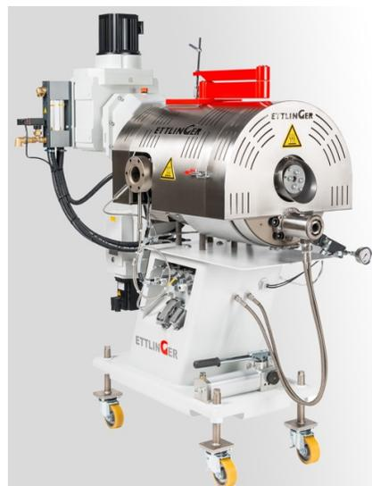
Come tutti i modelli ERF - spiega l'azienda - anche questa macchina è in grado di filtrare inquinanti come carta, alluminio, legno, elastomeri o plastiche che fondono a temperature più elevate, con livello di contaminanti fino al 18%. Inoltre, il nuovo filtro può essere integrato facilmente in reparti Industria 4.0.
