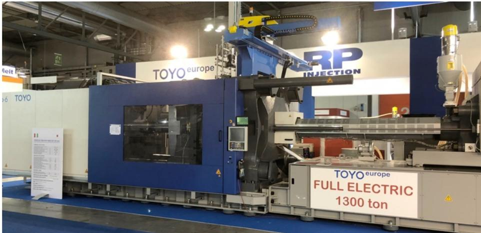
Una pressa completamente elettrica con forza di chiusura di 1.300 tonnellate (12.740 kN), modello Si-1300-6, costruita da Toyo, stampa in questi giorni a Plast 2018 cassette pieghevoli in polipropilene. Si tratta del modello più grande della serie Si-6, ad azionamento completamente elettrico, proposta dal costruttore giapponese, rappresentato in Europa dalla R.P. Injection di Azzano Mella (BS).
