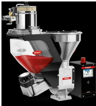
L'elevata precisione, che può arrivare fino a  $\pm 0,03\%$ , è frutto del sistema anti-vibrazioni, dell'algoritmo di controllo della macchina con autocalibrazione e della tramoggia svincolata dal corpo del dosatore.
