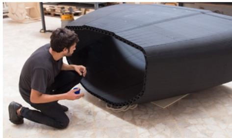
stampato un blocco di prua dell'imbarcazione dal peso contenuto e dalle elevate caratteristiche di rigidità e finitura superficiale (nella foto). Il processo, completamente automatizzato ha richiesto tre giorni h24 per depositare strati spessi 0,6 mm con pareti spesse 1 mm.
