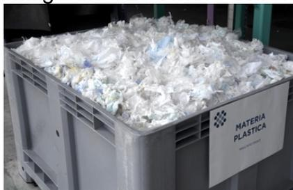
I pannolini e gli altri prodotti assorbenti giungono all'impianto dopo la fase di raccolta e trasferiti direttamente all'autoclave, dove ha inizio il processo di riciclo. Qui, attraverso vapore a pressione e senza combustione, vengono aperti e sterilizzati. Una volta completato il ciclo, i prodotti vengono lacerati e le loro componenti riciclabili separate in plastica, cellulosa e polimero super assorbente. Fater Smart è una divisione di Fater Spa, joint
