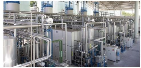
possono essere recuperate fino a 38mila t/a di anidride carbonica, che in forma liquida è destinata ad uso tecnico ed alimentare. Avviato nell'estate dell'anno scorso, l'impianto ha una capacità produttiva pari a 32 milioni di metri cubi di gas l'anno, alimentato esclusivamente dal trattamento dei rifiuti organici della raccolta differenziata urbana.
