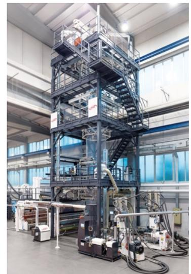
Le tre linee bolla sono identiche, con configurazione a 3 strati per film shrink in PE, larghezza netta di 2.400 mm e capacità produttiva pari a 800 kg/h con 50 µ di spessore. L'anello automatico 'rinsing type' di ultima generazione permette un controllo preciso dello spessore con
