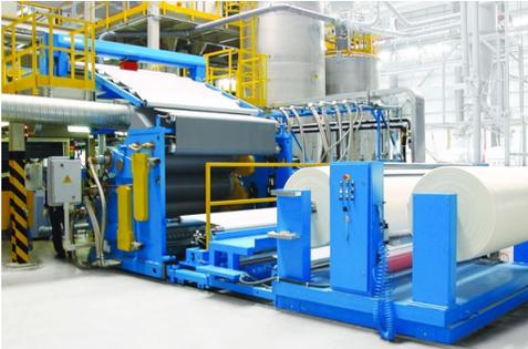
Sono costruite in Italia, presso gli stabilimenti novaresi di Amut, le due nuove linee chiavi in mano per l'estrusione di membrane impermeabilizzanti in PVC e TPO che consentiranno al gruppo cinese Jiangsu Canlon Building Materials di incrementare la capacità produttiva, portandola da 10 milioni a 25 milioni di metri quadrati l'anno.
