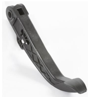
In questo componente, l'acciaio normalmente utilizzato per il corpo è stato rimpiazzato con una struttura ibrida leggera. Skeleton è infatti composto da una barra di supporto in composito, sovrastampata con Technyl Max, poliammide 66 rinforzata con il 60% di fibra di vetro: in questo modo si ottiene una resistenza alla rottura con carichi fino a 3.000 N, ben superiore alla forza media che viene applicata sul pedale in caso di una frenata di emergenza, nell'ordine di 500 N.
