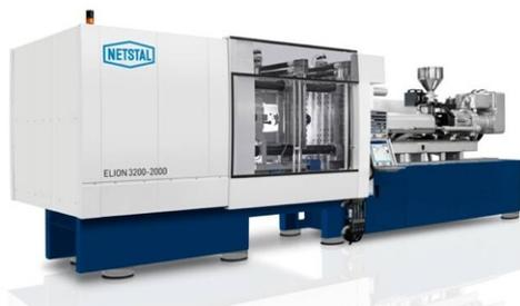
Le presse ad iniezione Netstal Elion di KraussMaffei che montano il sistema di controllo aXos (dalla versione 8.2.0. in avanti) possono beneficiare di un incremento del tempo di ciclo a vuoto fino a 0,2 secondi grazie ad un'ottimizzazione di tipo adattativo delle rampe di accelerazione e decelerazione del gruppo di chiusura, introdotta su tutta la serie e applicabile anche alle macchine già installate.
