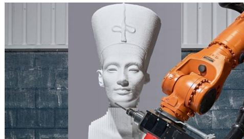
Per produrre oggetti e scenografie dall'aspetto realistico, anche di grande dimensione, si parte da un blocco di polistirene espanso sinterizzato (EPS), materiale leggero e facilmente lavorabile, che viene scolpito dal robot mediante fresatura sulla base di un disegno CAD, ottenuto dalla scansione del modello; il manufatto viene poi rivestito con schiuma poliuretana e altre resine indurenti che aumentano la resistenza e creano un substrato per la finitura decorativa.
