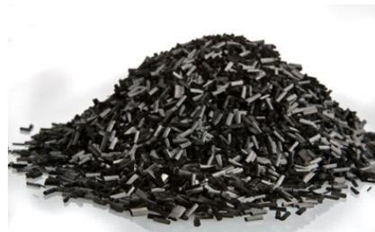
Le fibre tagliate (chopped) in lunghezza di 6 mm vengono utilizzate come rinforzo di materie plastiche all'interno di compound utilizzati in applicazioni tecniche, quando occorre garantire elevata resistenza meccanica e conduttività elettrica.
