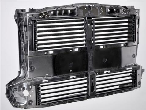
Per la realizzazione del 'bolster' integrato nel modulo front-end della nuovo SUV Kuga di Ford, la società tedesca Montaplast ha selezionato una soluzione ibrida plastica-metallo, utilizzando - per la parte polimerica - una poliammide 6 ad alto scorrimento rinforzata con 30% fibre di vetro fornita da Lanxess (Durethan BKV30H2.0EF).
