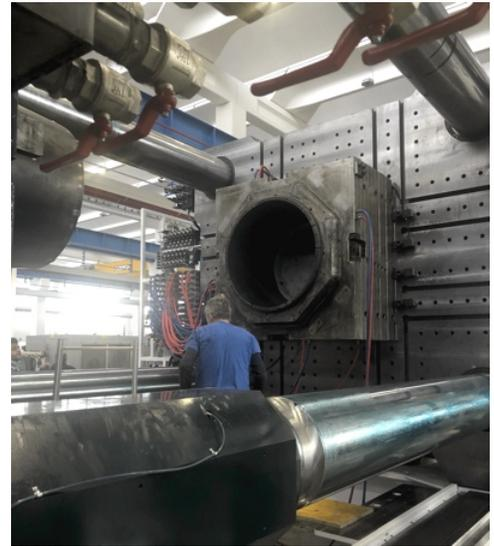
La corsa di apertura è pari a 4.100 mm, mentre il passaggio tra le colonne (H x V) è di 2.500 x 2.000 e la distanza massima tra i piani è pari a 5.400 mm. Con un diametro vite di 235 mm, la pressa è in grado di iniettare fino a 52.048 cm<sup>3</sup> di PS (49.446 grammi) con pressione di iniezione di 1.724 kg/cm<sup>2</sup> e capacità di iniezione di 2.800 cm<sup>3</sup>/s.
