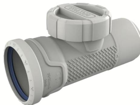
Il compound selezionato, di colore grigio chiaro, presenta una densità di  $1,9 \text{ g/cm}^3$ , modulo di elasticità di  $1800 \text{ N/mm}^2$  e coefficiente lineare di dilatazione termica di  $0,06 \text{ mm/mK}$ .
