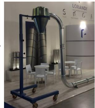
Per quanto concerne i sistemi di trasporto pneumatico utilizzati per lo stoccaggio e l'alimentazione di materie prime plastiche agli impianti di trasformazione, la società bresciana è in grado di fornire una gamma completa di tubazioni, collegamenti, separatori d'aria e collettori per garantire il puntuale collegamento con la macchina in produzione.
