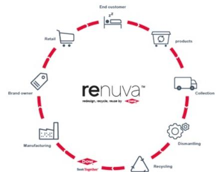
I polioli, a loro volta, vengono impiegati - miscelati con quelli vergini - per ottenere poliuretano destinato alla produzione di nuovi materassi e in altre applicazioni. Il poliuretano in parte da riciclo sarà utilizzato, per esempio, da Vita Group per produrre schiume flessibili a marchio Orbis per il mercato degli imbottiti.
