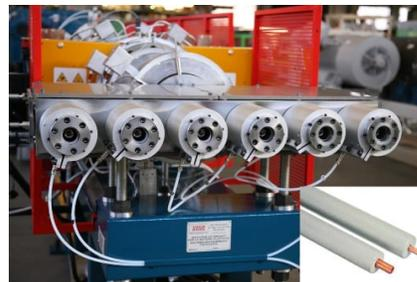
La linea integra due processi che operano in modo sinergico: estrusori bivate per la produzione delle guaine ed estrusori monovite per il rivestimento, equipaggiati con distributori a 4 teste intercambiabili per l'estrusione di 2 o 4 guaine alla volta. Gli estrusori sono dotati di un sistema di filtrazione per consentire l'utilizzo di plastiche riciclate.
