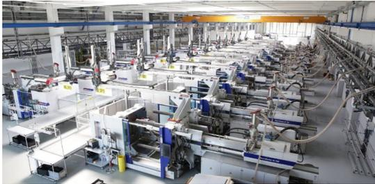
Nella fabbrica rumena di CER Cleaning Equipment, società del gruppo tedesco Kärcher, nell'ultimo anno sono state installate 18 nuove presse ad iniezione serie MacroPower, complete di sistemi ausiliari e automazioni, fornite dal gruppo austriaco Wittmann. Le presse sono utilizzate per produrre i componenti in plastica delle attrezzature per la pulizia domestica e
