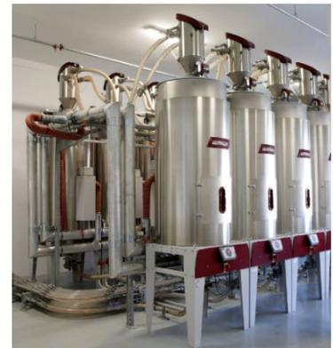
L'intero stabilimento è dotato di un sistema centralizzato di deumidificazione e trasporto dei granuli, collegato con silos esterni dotati di controllo gravimetrico. Internamente viene anche effettuato il riciclo degli sfridi potenzialmente riutilizzabili in produzione.
