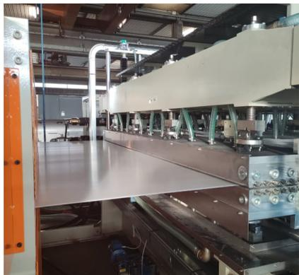
Union Officine Meccaniche ha completato il collaudo, presso la sede di San Vittore Olona (MI), di una linea completa per la produzione di lastre alveolari in polipropilene con larghezza di 2.800 mm e capacità fino a 1000 kg/h destinata al mercato nordamericano.
