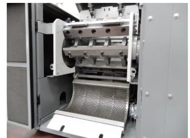
Non mancano accorgimenti per favorire l'accessibilità a fini di pulizia e manutenzione. Le operazioni possono essere eseguite accedendo alla macchina dalla parte anteriore, ribaltando la tramoggia di alimentazione, assistita da un cilindro pneumatico. Le operazioni di pulizia richiedono pochi minuti e non necessitano di utensili specifici.
