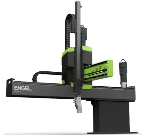
Il nuovo Viper 4 - che sarà presentato ufficialmente al K 2022 di Düsseldorf - impiega per la prima volta la tecnologia di azionamento a bassa tensione (48 V, con alimentazione monofase da 230 V CA) che migliora l'efficienza energetica riducendo i consumi, contribuendo a contenere anche l'impronta di carbonio dello stampaggio.
