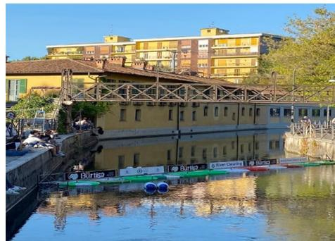
Battezzato 'River Cleaning Plastic', il sistema si compone di tre elementi. Il primo è un cavo sopraelevato in acciaio che, estendendosi da una sponda all'altra, ha la funzione di ancorare i dispositivi di setacciamento. Una serie di "giranti galleggianti" del diametro di 110 cm in materiale plastico indirizzano i rifiuti galleggianti (fino a una profondità di 35 cm) verso un contenitore per la raccolta.
