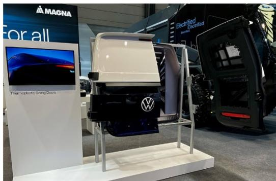
Il fornitore OEM di componenti Magna ha messo a punto un doppio portellone posteriore a battente in materiale termoplastico destinato a equipaggiare il nuovo van elettrico ID. Buzz di Volkswagen.
