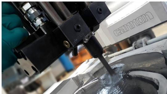
Un nuovo sistema di miscelazione multicomponente, dedicato al riempimento ignifugo di grafite espandibile per schiume poliuretatiche, EG-AX, è stato presentato da Cannon Afros al K2022.
