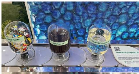
Il terzo processo, basato sulla pirolisi beneficerà dell'esperienza di Plastic Energy, mentre per il post-trattamento dell'olio di pirolisi SK Geo Centric utilizzerà una tecnologia proprietaria. La capacità produttiva sarà pari a 66mila tonnellate annue di rifiuti, che salirà a quasi 100.000 t/a al termine della fase di trattamento. I lavori di
