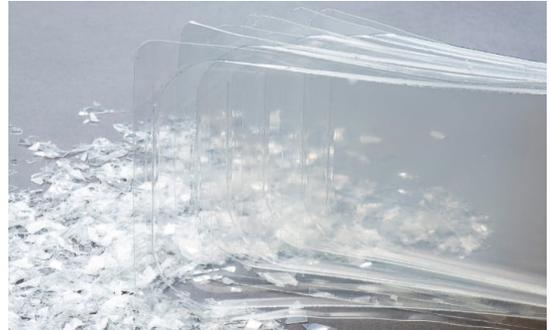
Le prove su scala industriale, condotte nei mesi scorsi presso un impianto pilota gestito da Krones a Flensburg (Germania), hanno dimostrato la possibilità di separare completamente fino al 69% dei componenti di un film PET/PE da termoformatura e ottenere una separazione parziale per un ulteriore 12%.
