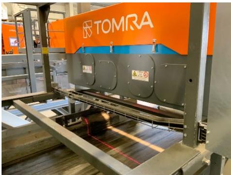
Prima però, occorre separare i film multistrato riciclabili dal flusso dei rifiuti e a questo provvede la tecnologia per la selezione delle materie plastiche Autosort di Tomra, basata su NIR, in grado di rilevare i contenitori in PET multistrato contenenti l'adesivo da "debonding".
