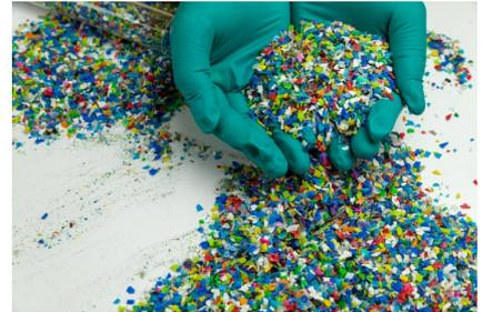
Il costruttore austriaco di presse a iniezione Engel è stato selezionato dalla giuria nella categoria Macchine per riciclo grazie alla tecnologia a due stadi, con interposti degasaggio e filtrazione, capace di stampare partendo direttamente da scaglie ed eliminando così la fase di granulazione ([leggi articolo](#)).
