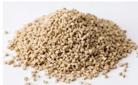
I granuli così ottenuti, dopo il processo di compounding, contengono fino al 50% di riciclato con resistenza meccanica pari ad almeno il 90% rispetto alla versione standard con materia prima vergine.
